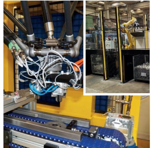
Robot pour automatiser le chargement, à partir de pièces en vrac
