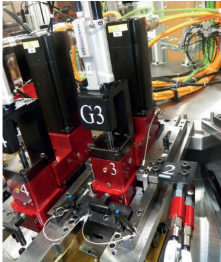
Contrôle de taraudage (garanti 100% trous taraudés)
