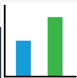
Augmentation de la durée de vie des tarauds de 60% par rapport à un taraud avec lubrification externe.
