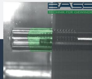
L'utilisation de tarauds avec lubrification par le centre garantit la continuité de la lubrification des parois du collet avant la création de filets par déformation des filets.
