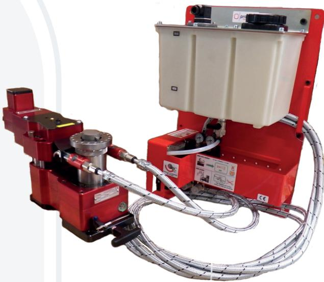
Parce que la durée de vie des tarauds dépend directement de la qualité de la lubrification, PRONIC a développé un système de microlubrification adapté au taraudage sous presse, équipé de raccords rapides sur les appareils à tarauder.
