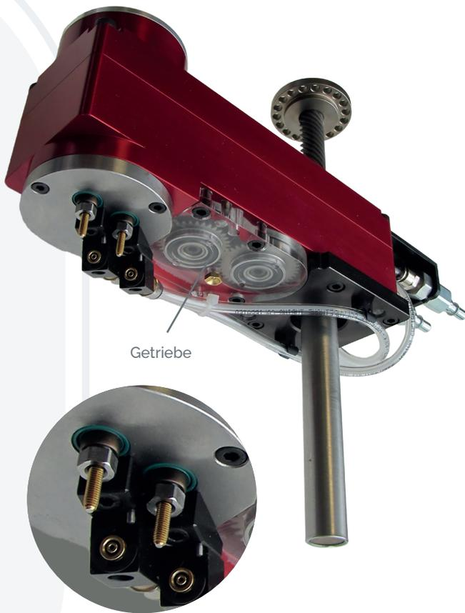
**Diese Geräte kommen vor allem im Bereich der Konnektoren zum Einsatz und besonders dann, wenn sehr kleine Mittenabstände gefragt sind, feine Gewindebohrer benutzt, eine hohe Anzahl an Pressenhüben ausgeübt wird und der für den Einbau der Einheit zur Verfügung stehende Platz nicht sehr groß ist.**
