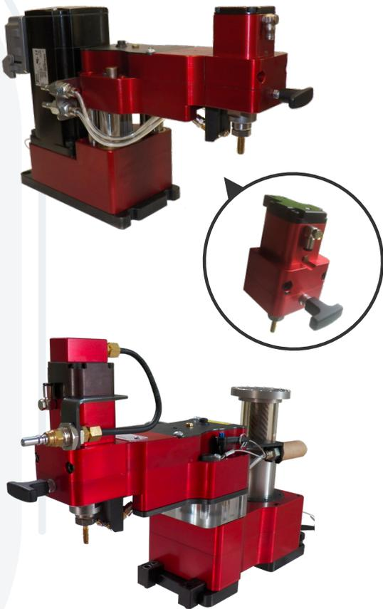
**Appareil à tarauder monobroche avec tête détachable, suivi de bande intégré et des options inédites.**
